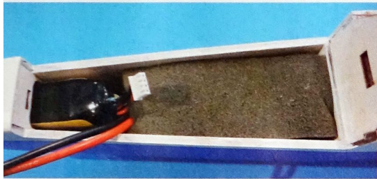
Der Flugakku kommt so weit wie möglich nach vorne und wird in dieser Position mit Schaum gesichert.
