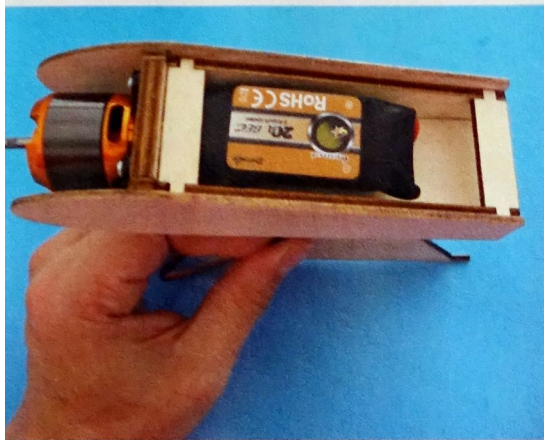
Der optionale Elektroantrieb mit D-Power-Komponenten sitzt ganz klassisch in einem Motoraufsatz.
